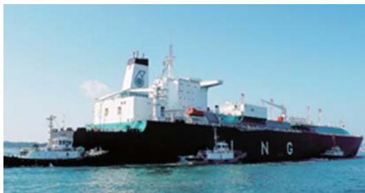
LNG船の曳航作業
