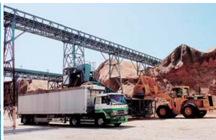
ショベルローダーとコンベヤーでウッドチップを搬出
