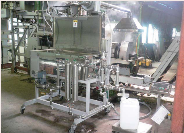
(株)寺田製作所と共同開発した捕集装置(特許申請中)で茶葉の蒸気を回収
