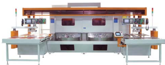
硝子端面・穴加工精密CNC加工装置 Honesty SG FOUR-15CCD
