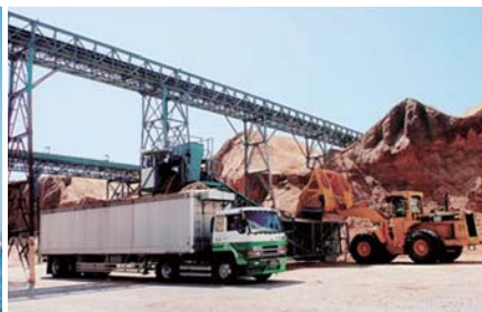
ショベルローダーとコンベヤーでウッドチップを搬出
