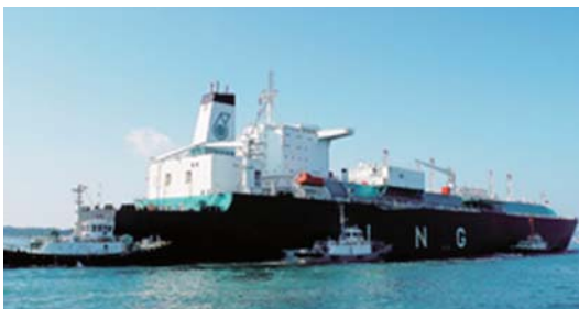
LNG船の曳航作業
