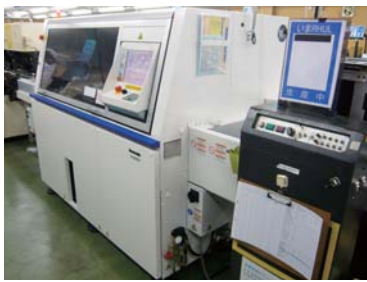
新規導入されたラジアル挿入機
