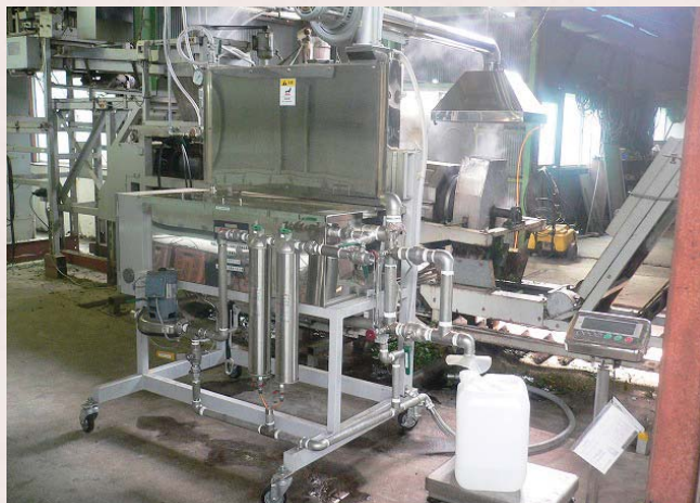
(株)寺田製作所と共同開発した捕集装置(特許申請中)で茶葉の蒸気を回収
